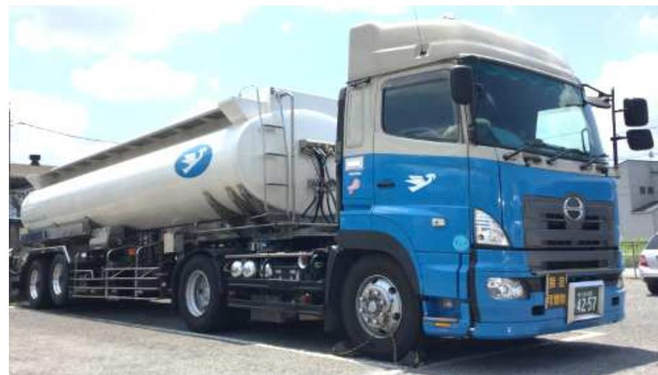
油脂用タンクセミトレーラー ≪最大積載量：20,600 kg≫
