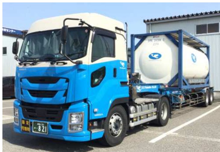
ISOタンクコンテナ ≪最大容量：26KL≫
