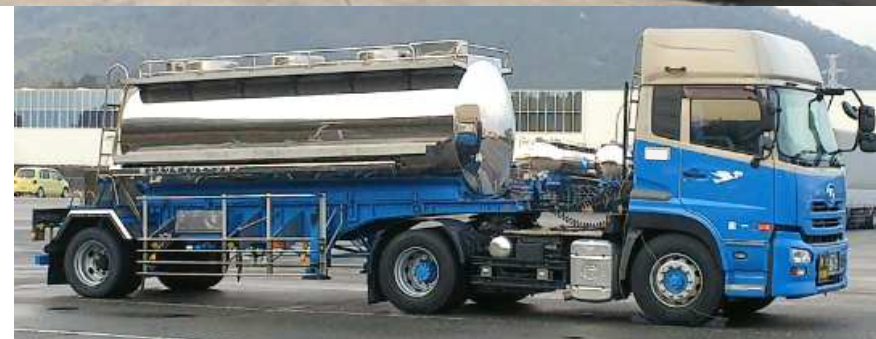
液糖用タンクセミトレーラー ≪最大積載量：11,300～20,160 kg≫
