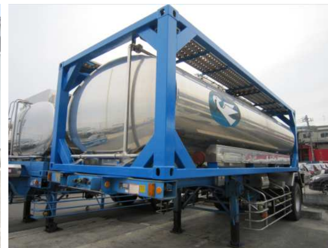
積載式タンクコンテナ ≪最大容量：14KL≫
