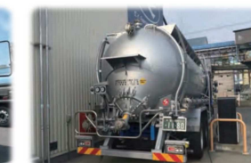
ダンプアップタイプローリー 小麦粉 比重 0.5/kg/m 3
